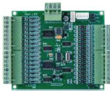
Convertisseur série-parallèle qui transmet les signaux CanBus reçus des boutons de série aux systèmes de panneaux de commande fonctionnant en parallèle.
