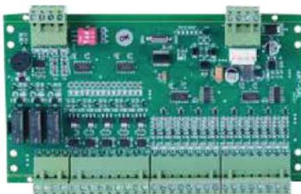
Lorsque la connexion parallèle du bouton au panneau de commande ART-1 est souhaitée, la carte SRL est utilisée comme convertisseur CanBus. La carte SRL permet les connexions en parallèle jusqu'à 16 étages et la connexion des boutons de cabine.
