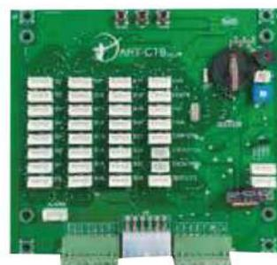
Grâce à la communication CanBus, il permet de transférer les indicateurs, les boutons d'appel et d'autres composants du bouton de cabine vers la boîte de révision avec un seul câble.
